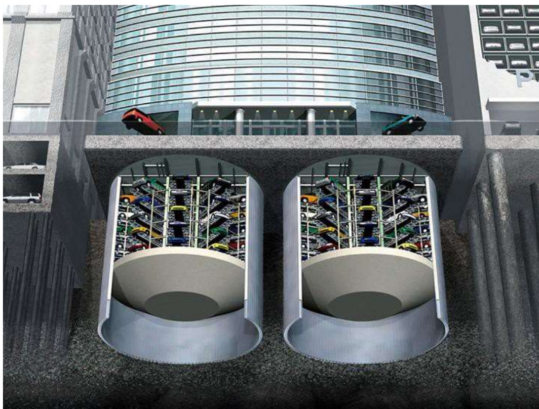
Рисунок 40 – Примеры решений наземных и подземных механизированных стоянок
